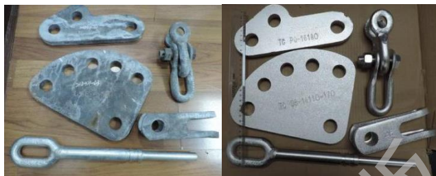
图4: 系列金具耐磨减磨处理前后对比
