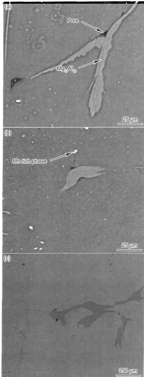
图 3 焊核区金属间化合物的背散射电子像
