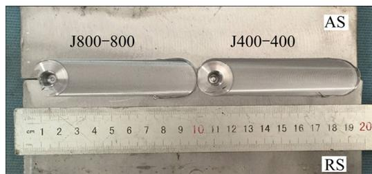
图 1 Pb-Sn 合金轧板 FSW 焊缝表面形貌
