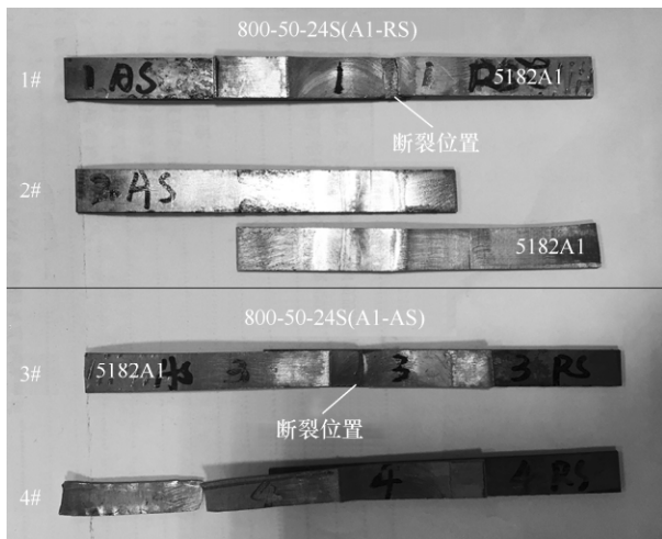
图 7 800-50-24S 样品拉伸剪切断裂后典型形貌
