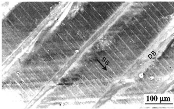
图 4 Cu 单晶体高应变疲劳粗大形变带的形成
